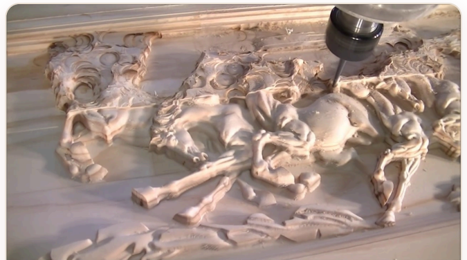
Ejemplo de grabado y relieve en madera con CNC
